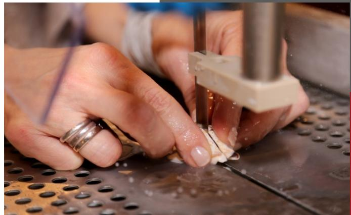
Verbundwerkstoffen für histologische Auswertung konzipiert und deshalb ausschließlich für diese Verwendung beschränkt. Zum Trennschleifen wird ein mit Diamant beschichtetes, hochgenaues Trennband eingesetzt.
